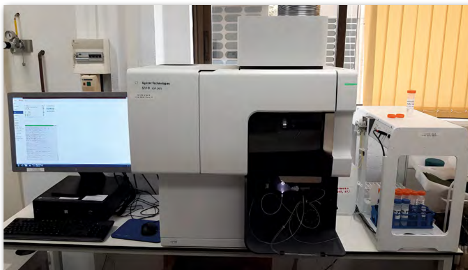
Figura 5. Espectrómetro de emisión óptica con plasma acoplado inductivamente.
