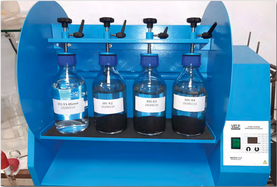
Figura 3. Dispositivo rotatorio empleado en el ensayo de volteo.
