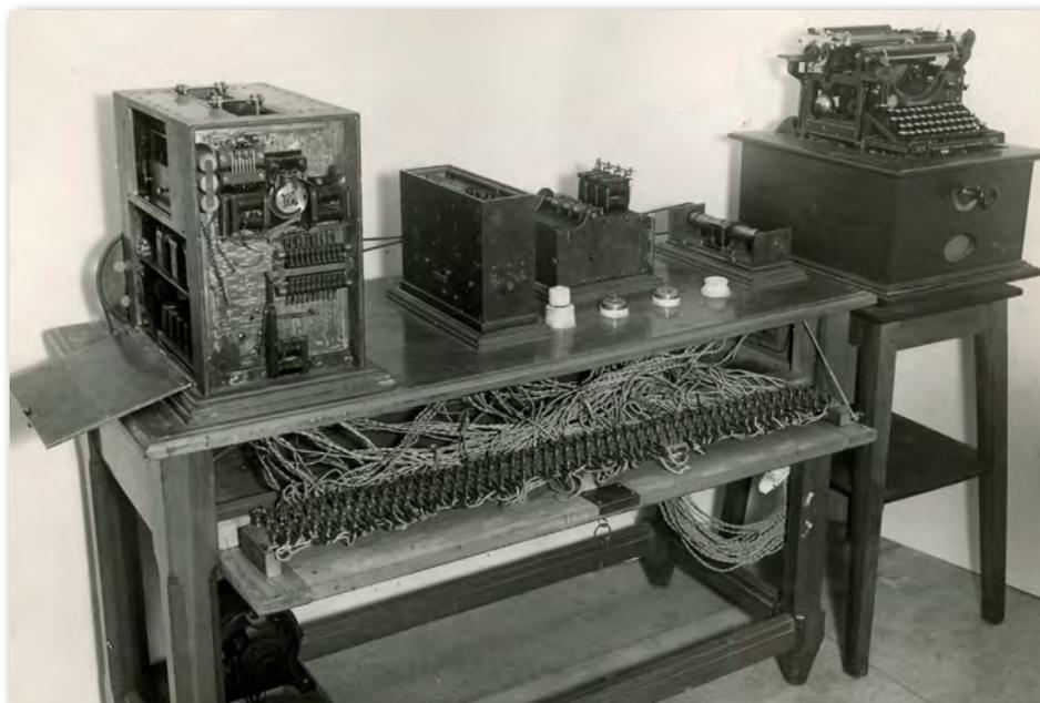
**Figura 14.** El *aritmómetro electromecánico* de 1920.
