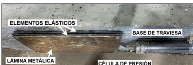
Figura 8. Detalle del montaje de la célula de presión bajo traviesa.
