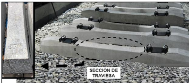
**Figura 1.** Sección de traviesa utilizada en los ensayos.
