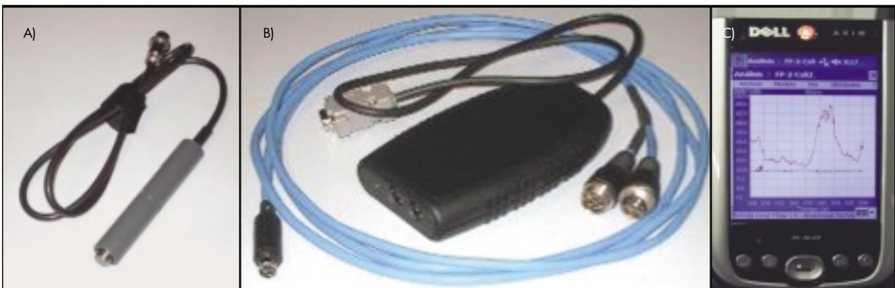
FIGURA 12. Equipo IDF utilizado para las mediciones. A) Sensor de conductividad. B) Interface. C) PDA.
