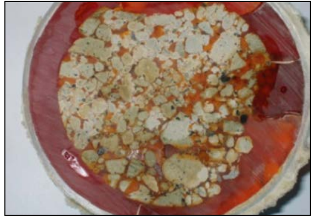
Figura 18. Muestra de piroclasto inmersa en resina coloreada para observar mejor su macroestructura.
