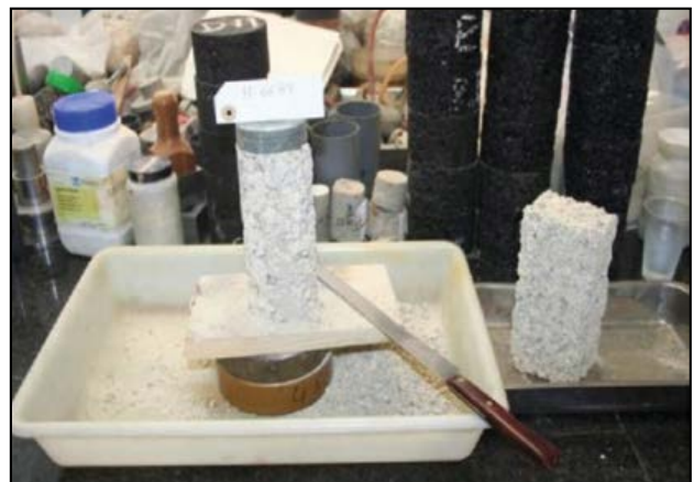
Figura 24. Tallado manual de una muestra de pumita.
