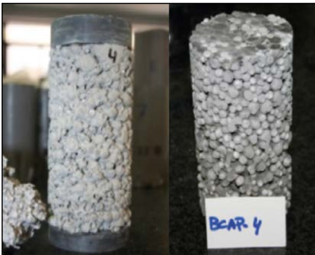
Figura 21. "Piroclasto ideal", con estructura reticular.
