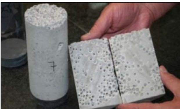
Figura 22. "Piroclasto ideal", con estructura vacuolar.
