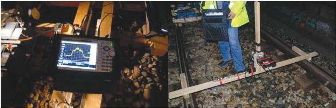
FIGURA 15. Registro de la señal de up-link de eurolazo para la medida de la intensidad de campo.
