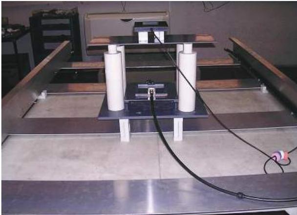
FIGURA 11. Calibración antena ERTILA usada para altas potencias de emisión.
