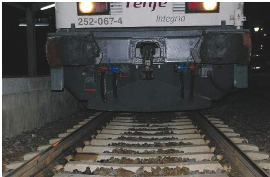
FIGURA 17. Locomotora de pruebas sobre vía con eurolazo.
