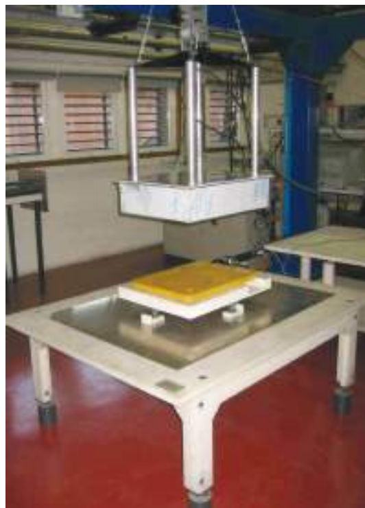
FIGURA 9. Ensayo con placa metálica bajo el Reference Loop.
