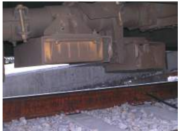
FIGURA 2. Antena instalada en el tren.
