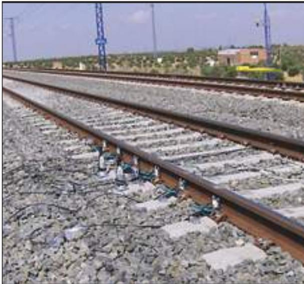
FIGURA 4.3. Disposición de los geófonos de 2 Hz de la sección S1 en la vía 1 en septiembre de 2008.
