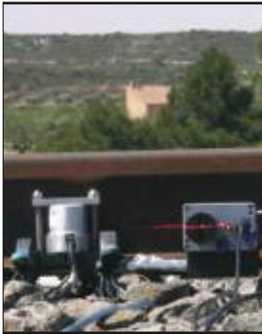
FIGURA 3.2. Sistema de haz láser y geófono de 2 Hz usado para calcular deflexiones en el carril.
