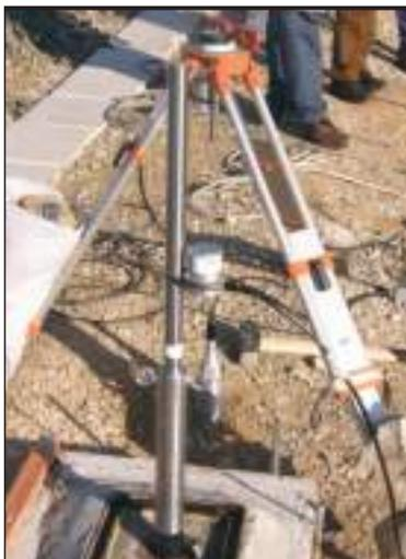
FIGURA 3.3. Barra fija y trípode usados como bases de referencia del emisor láser para las medidas de las deflexiones del carril.
