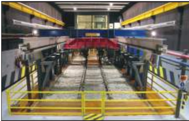
FIGURA 1. Vista superior de la célula de ensayos del CEDEX debidamente modificada para poder simular tráfico mixto.
