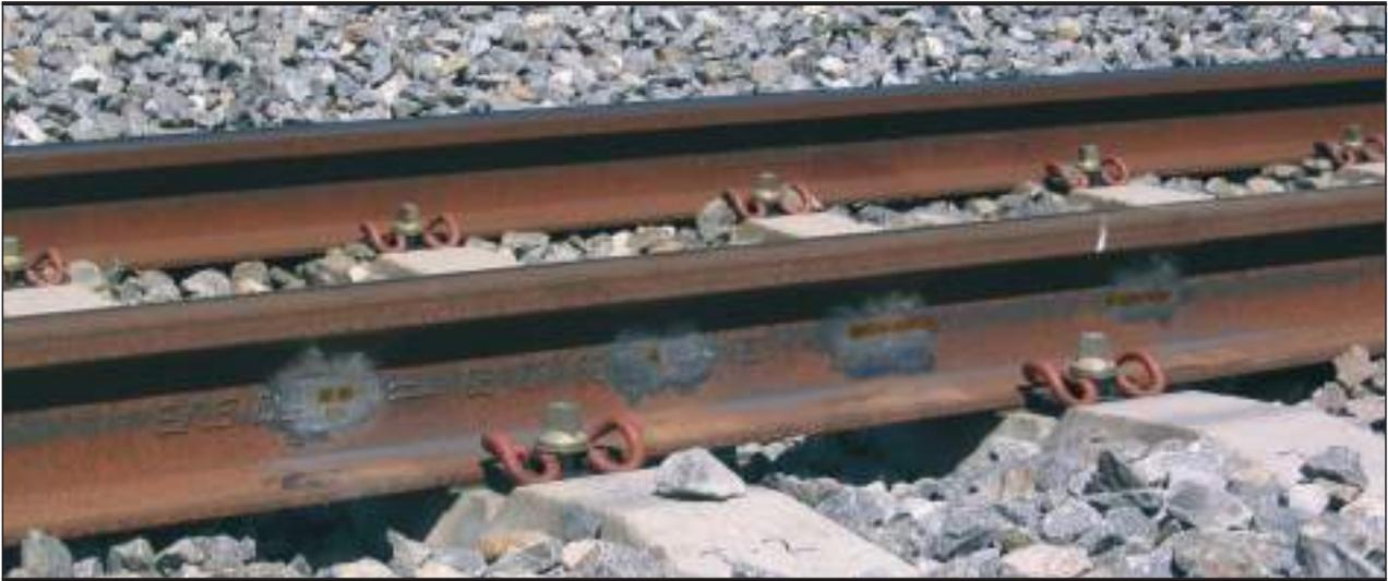
FIGURA 1. Situación donde se colocan las bandas para medir la carga sobre el carril y sobre la traviesa.
