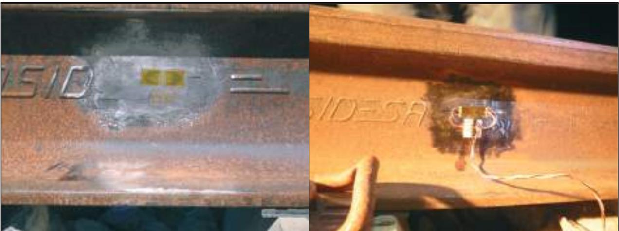
FIGURA 2. Vista del aspecto de una banda una vez pegada sin/con conexiones y previo a la protección final.
