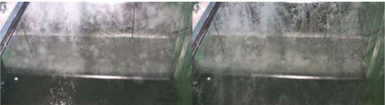
FIGURA 2. Detalle de un rebase con la acción del viento (izquierda) y sin ella (derecha). Fotografías tomadas con el mismo registro de oleaje y en el mismo instante.
