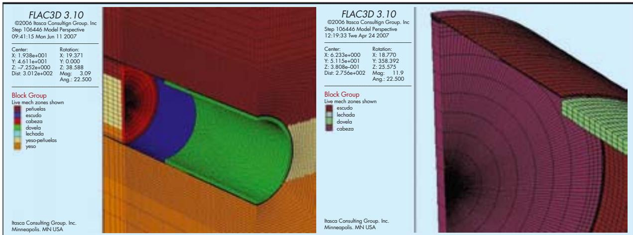
FIGURA 2. Mallado de la zona alrededor de la excavación y de la tuneladora y dovelas (Fe, M. y Lorenzo, J., 2010).
