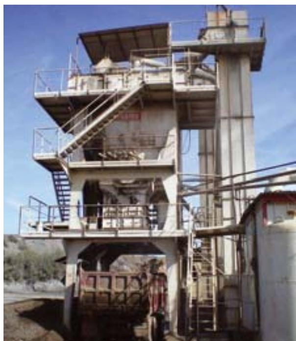
**FIGURA 2.** Central de fabricación de mezcla bituminosa.
