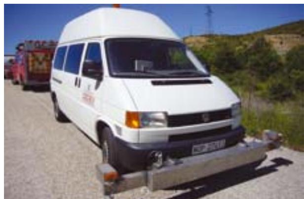
FIGURA 8. Equipo Greenwood Profilograph, perfilómetro láser del CEDEX.
