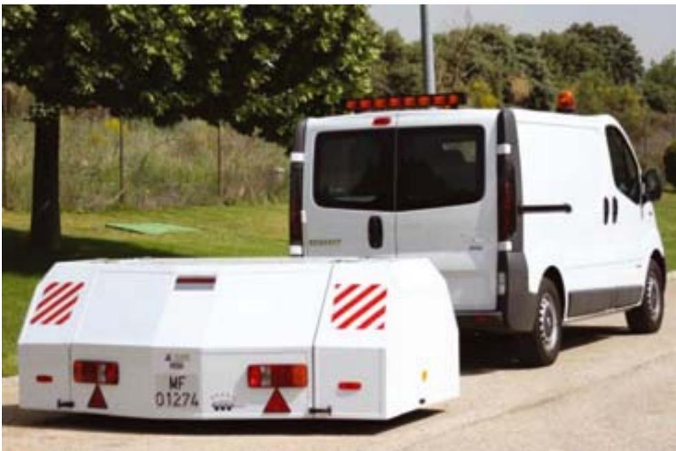
FIGURA 15. Equipo de medida del CPX del CEDEX.
