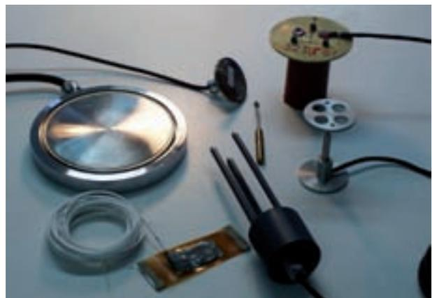
FOTOGRAFÍA 10. Ejemplo de sensores embebidos en los firmes.
