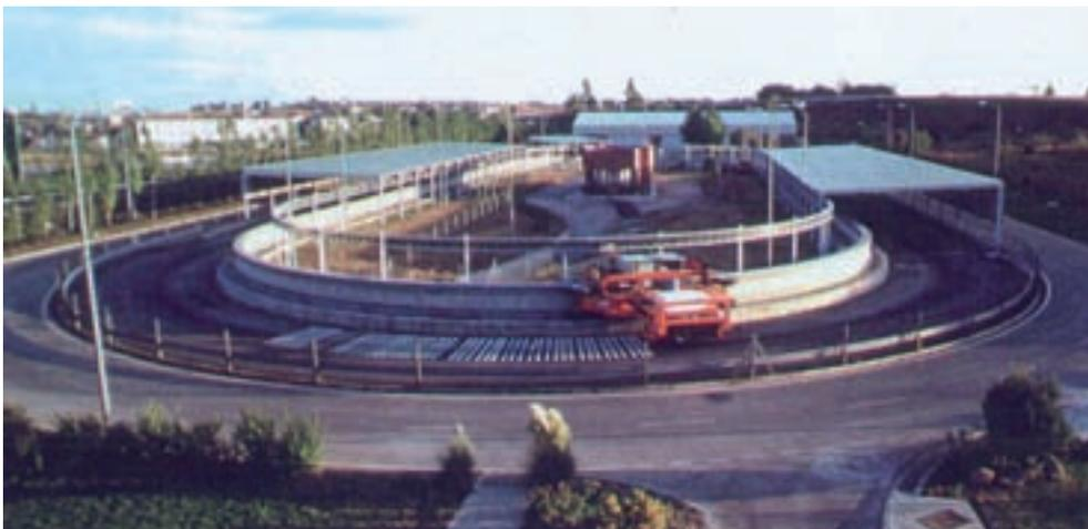
FOTOGRAFÍA 11. Ensayo de marcas viales en la pista.
