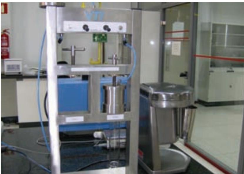
**FIGURA 5.** Equipo para la determinación de la pérdida de fluido por filtrado de las bentonitas.
