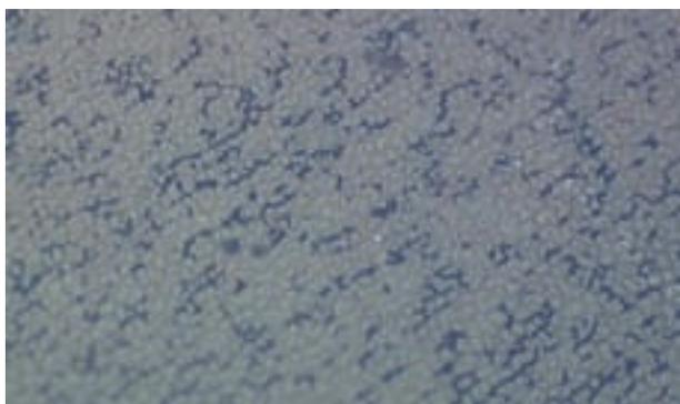
FIGURA 20. Aspecto de la cara externa de la geomembrana de PP extraída de la balsa de La Contraviesa a los doce años de su instalación (MOR x 60).
