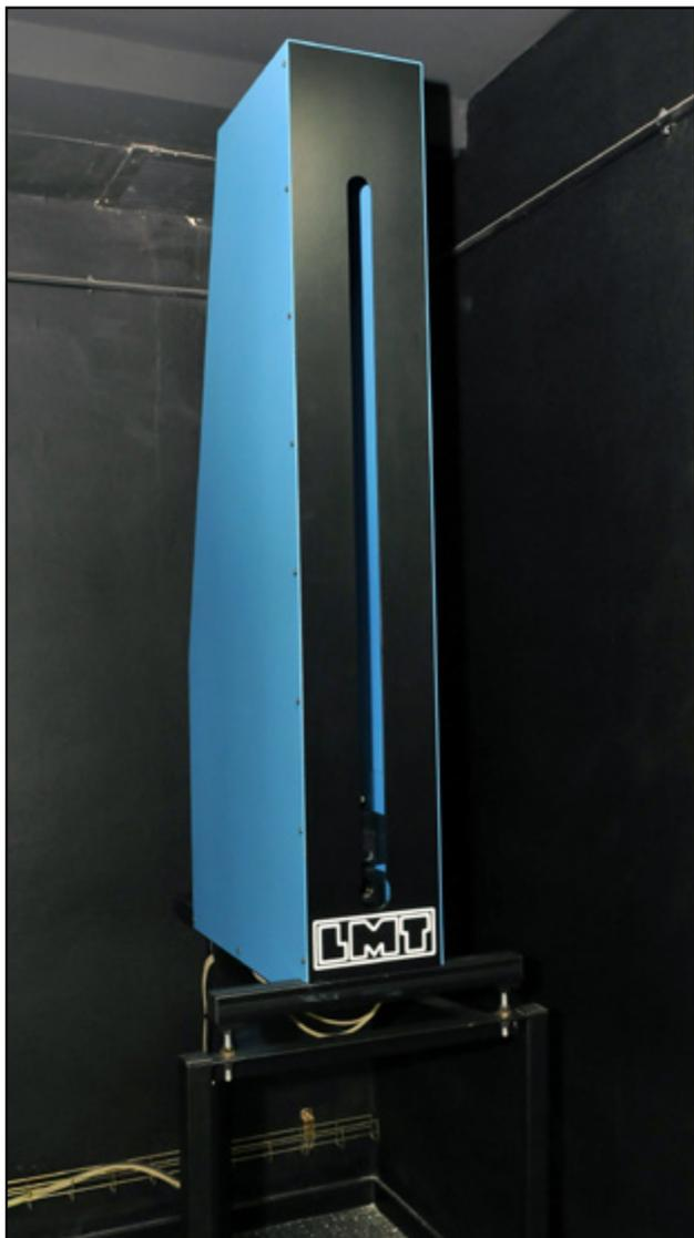
Figura 7. Retrorreflectómetro.
