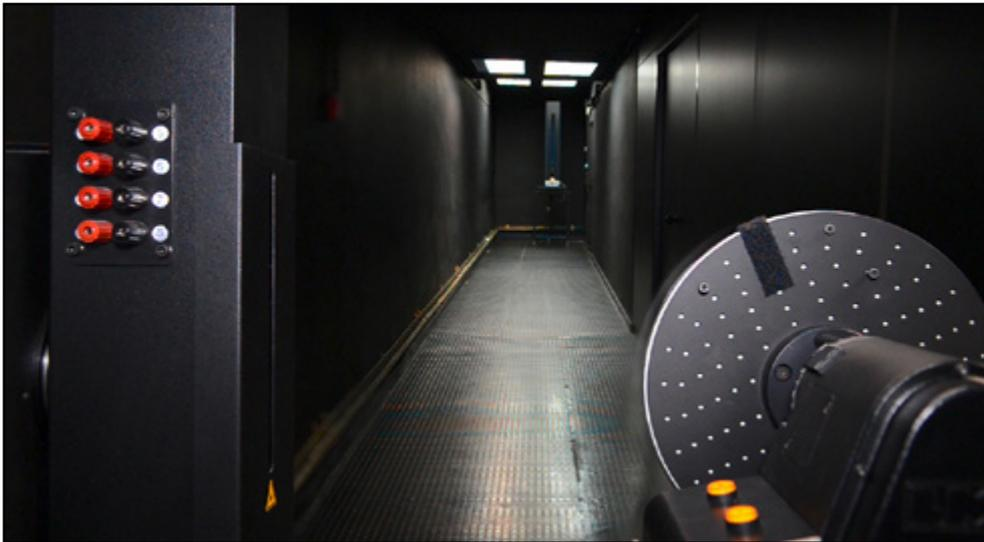
Figura 5. Zona de medición del Laboratorio de Fotometría del CEDEX, de más de 15 metros de longitud.
