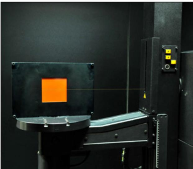
**Figura 9.** Detalle de la alineación de la muestra con el láser.
