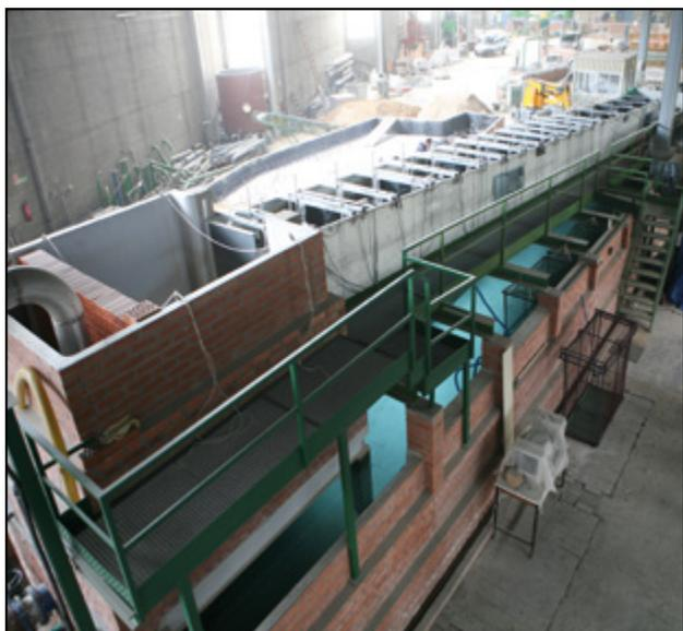
**Figura 1.** Escala construida en el Laboratorio de Hidráulica.
