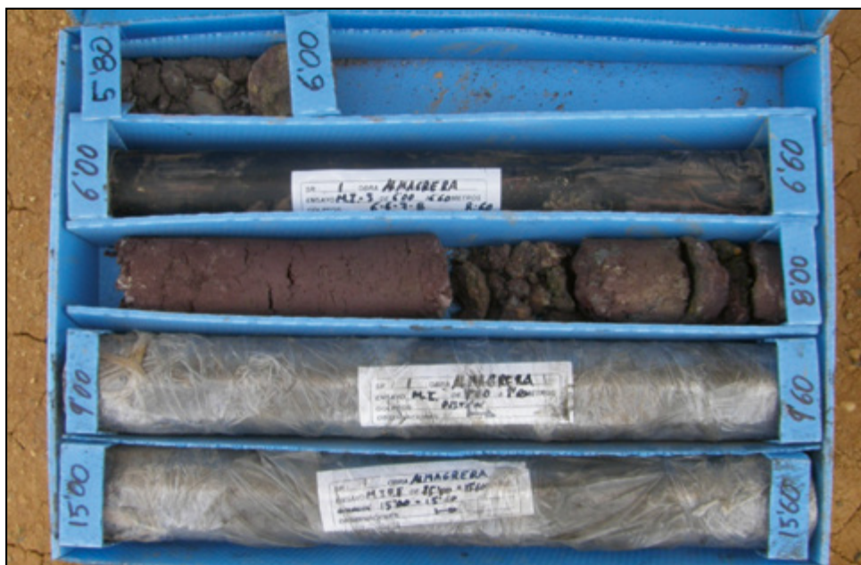
Figura 5. Material de Las Viñas hasta 8 m de profundidad. De esta profundidad en adelante lodos.
