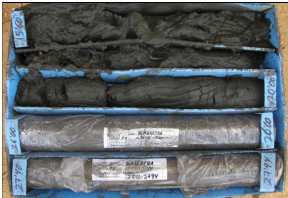
Figura 6. Los lodos en la parte final del sondeo.
