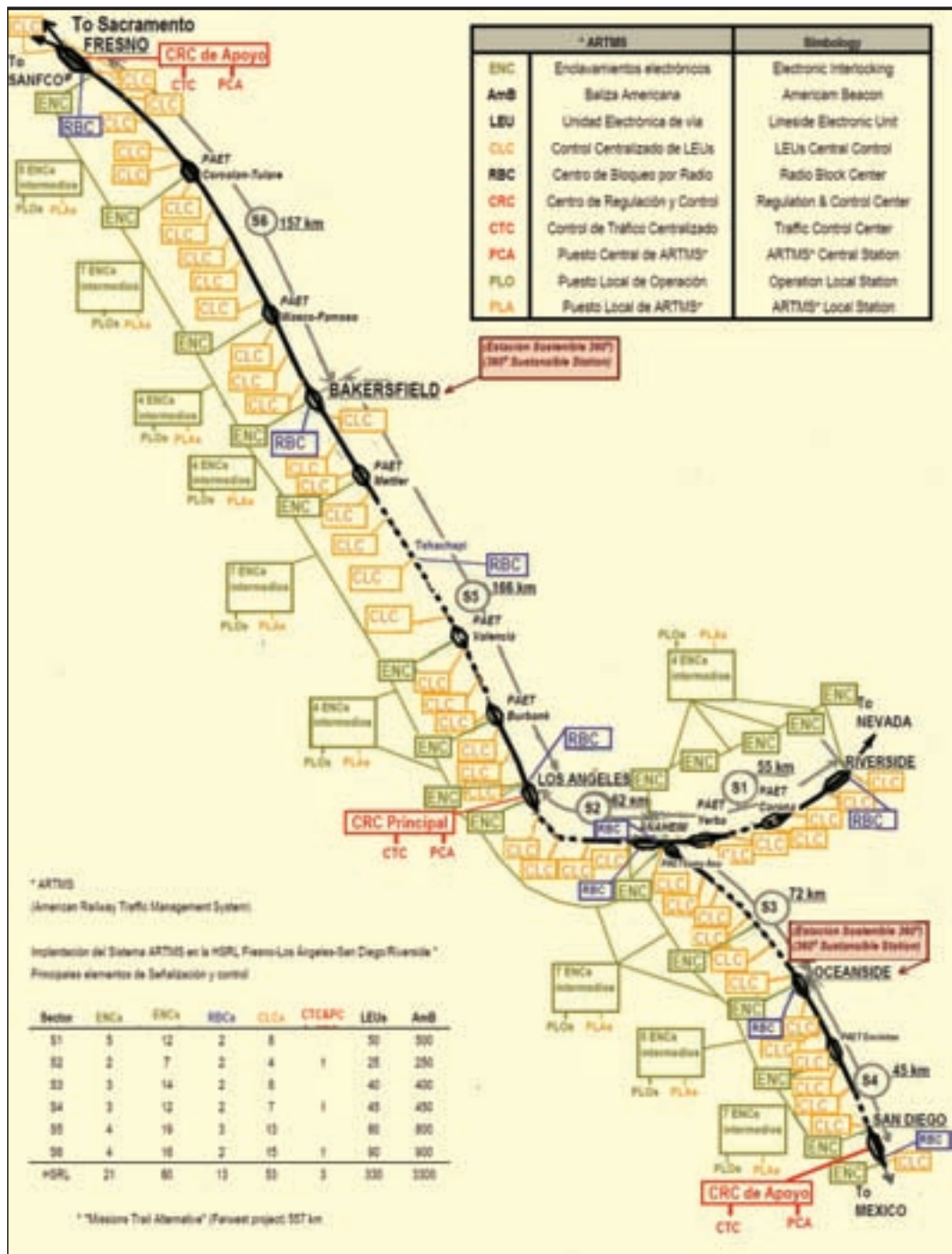
FIGURA 11. Esquema de Señalización de la LAV Fresno-Los Angeles-San Diego/Riverside / Signalling Schema on the Fresno-Los Angeles-San Diego/Riverside HSRL.
