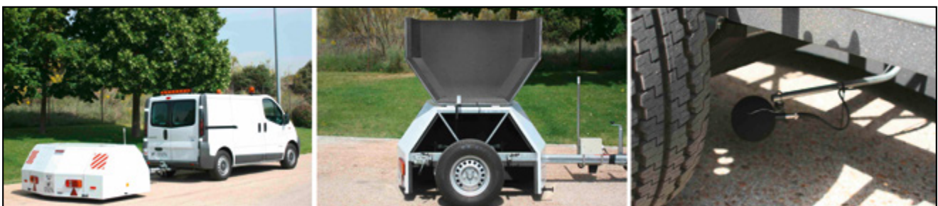
Figura 1. Equipo CPX del CEDEX. Vista general y detalles.
