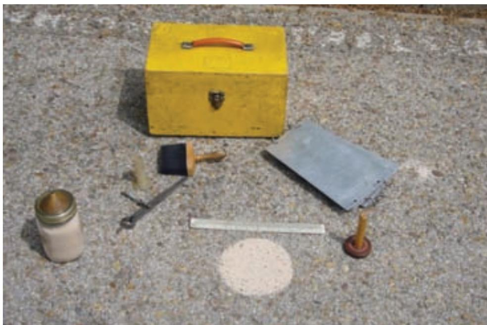
FIGURA 1. Ensayo del círculo de arena.
