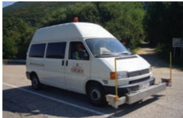
FIGURA 3. Perfilómetro Láser del CEDEX.
