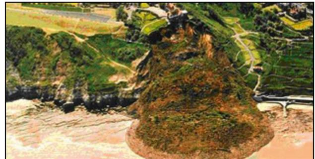
**Figura 4.** Deslizamiento rotacional de Holbeck, Reino Unido. (1993).
