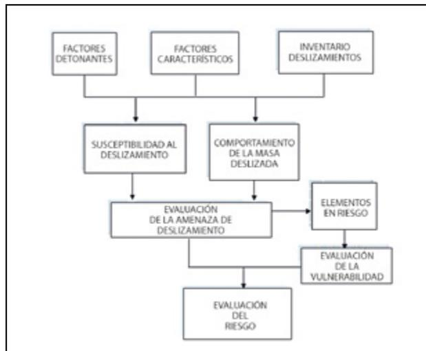
**Figura 10.** Proceso para la evaluación del riesgo por deslizamiento de laderas.
