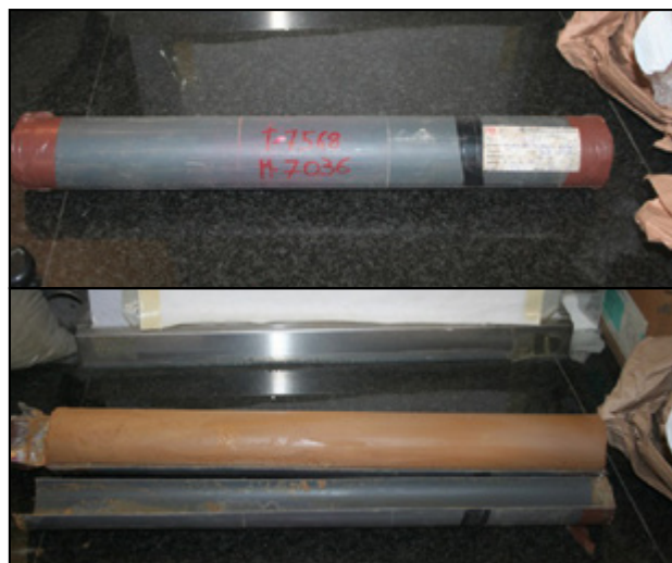
Figura 6. Testigo de la muestra de suelo obtenida del sondeo para el trabajo.
