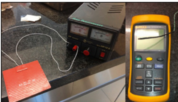
Figura 9. Resistencia, generador, termómetro y termopar empleados para la realización del ensayo térmico.
