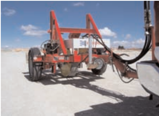
FIGURA 8. Ejecución de ensayo con el equipo portancímetro.
