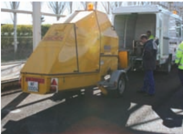
FIGURA 16. Fotografía del deflectómetro de impacto modelo KUAB 150.
