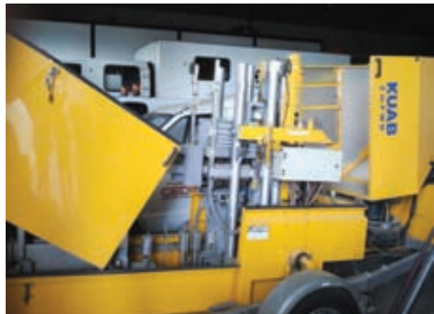
FIGURA 17. Fotografía del deflectómetro de impacto modelo KUAB 50.
