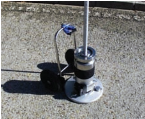
FIGURA 14. Fotografía del deflectómetro de impacto ligero Dynatest.
