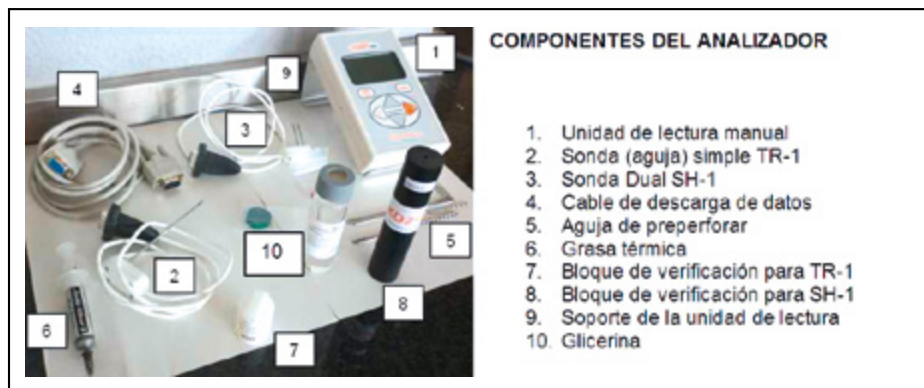
Figura 1. Analizador de propiedades térmicas KD2-PRO (DECAGÓN).
