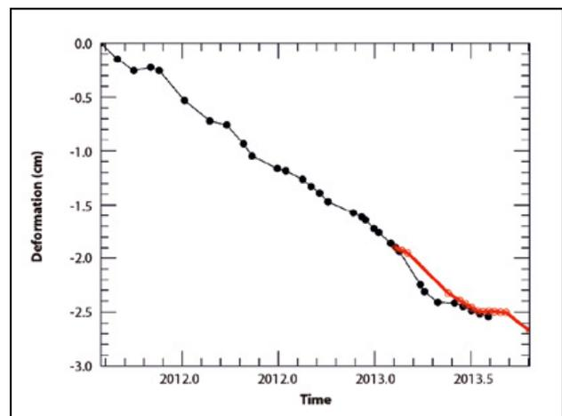
**Figura 17.** Comparativa de las series temporales de deformación obtenidas mediante el sensor CSK (negro) y TSX en modo Spotlight (rojo). Los resultados de TSX son preliminares (Fernández et al. 2014).
