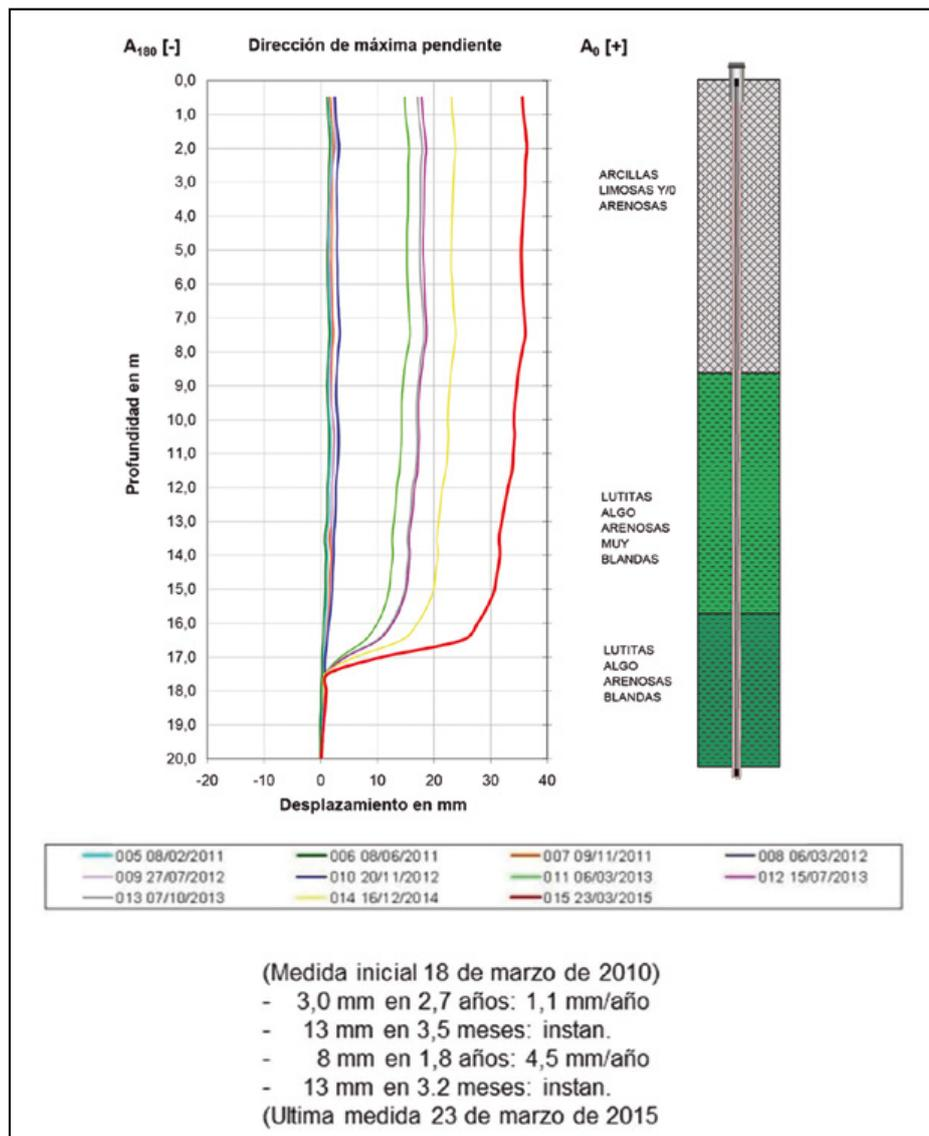
**Figura 6.** Evolución de movimientos horizontales en profundidad medidos en el inclinómetro SINC-1 y columna estratigráfica correspondiente. El plano de rotura se desarrolla en lutitas blandas muy meteorizadas.
