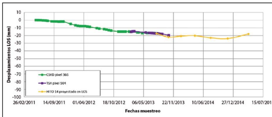
**Figura 20.** Deformación medida en el hito H14 (ver figura 12 para su localización) mediante NAP y GNSS y deformación de dos píxeles cercanos de CSK y TSX. Los valores horizontales (GNSS) y vertical (NAP) se han proyectado en la línea de visión del satélite TSX.
