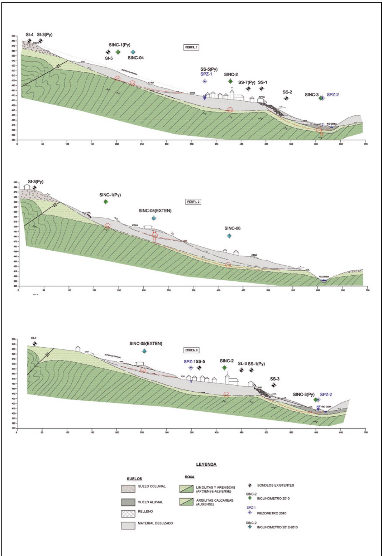
Figura 5. Perfiles (localizados en la figura 4) que muestran la hipótesis de inestabilidad.
