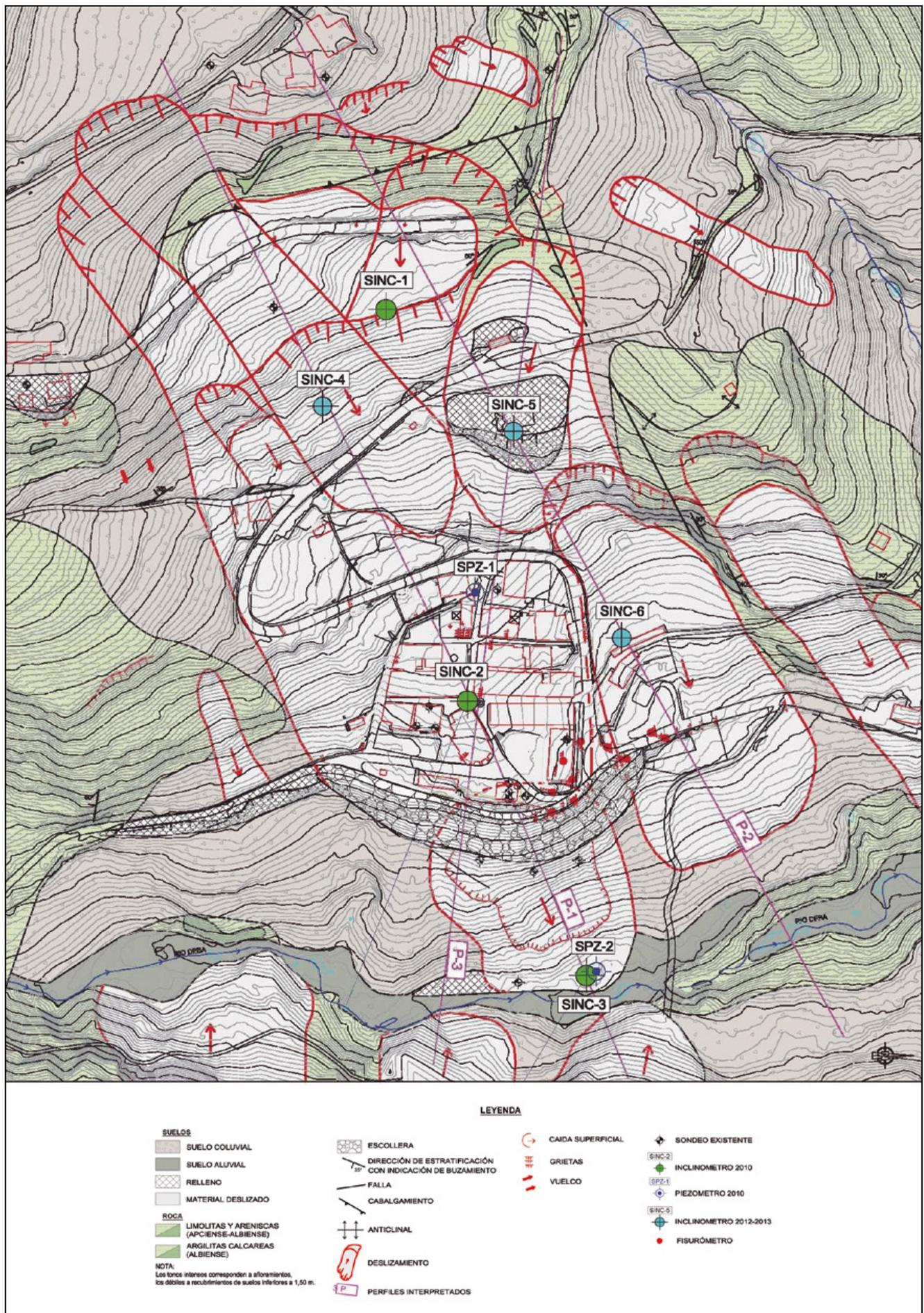
**Figura 4.** Mapa geológico-geotécnico local en el que están representados los elementos tectónicos, cartografía del deslizamiento, situación de los perfiles interpretados en la figura 5 y situación de la instrumentación geotécnica.
