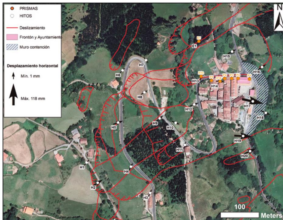
**Figura 12.** Localización de los hitos y prismas empleados en el control topográfico. La etiqueta E1 hace referencia a la localización de la estación robotizada. Las flechas indican la dirección del movimiento de los hitos en el plano horizontal y están escaladas en función del desplazamiento total acumulado medido en la sexta campaña del 20/11/2014 (ver gráficos figura 11).
