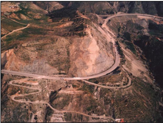
**Figura 3.** Patologías en la CN-323 por deslizamientos de ladera, en un tramo con estabilidad preliminar precaria, y destrucción de muros de tierra armada, como consecuencia de un largo período de precipitaciones.
