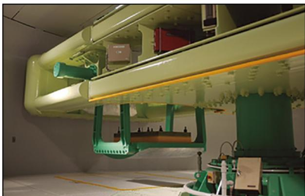
**Figura 1.** Centrífuga geotécnica del Instituto de Investigación de Puertos y Aeropuertos, Japón (PARI, 2014).
