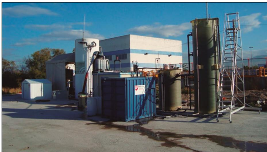
**Figura 1.** Visión general de la instalación experimental de microfiltración.
