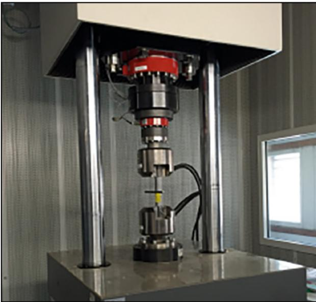
**Figura 11.** Ensayo de fatiga en máquina de resonancia magnética.
