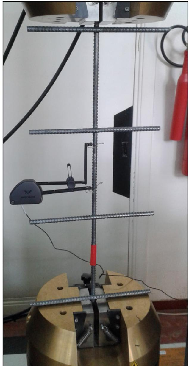
Figura 9. Ensayo de tracción de malla en máquina electromecánica.
