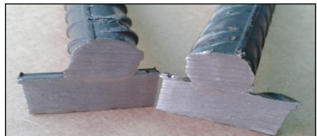
**Figura 13.** Detalle del corte, por su plano de simetría, de un nudo de malla electrosoldada, donde puede apreciarse la buena ejecución de la soldadura de unión.
