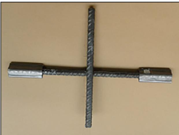
**Figura 12.** Detalle de la probeta para ensayar en máquina de resonancia magnética.
