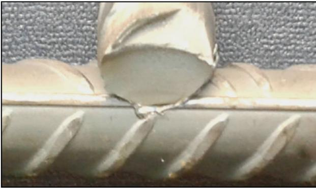
**Figura 18.** Fractura de fatiga en una malla S.
