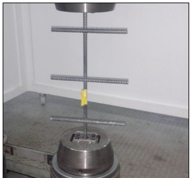
Figura 10. Detalle de probeta de malla con tres nudos en máquina servohidráulica.
