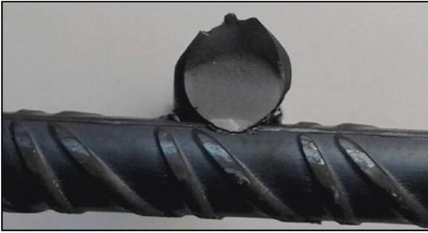
**Figura 17.** Fractura de fatiga en una malla SD.
