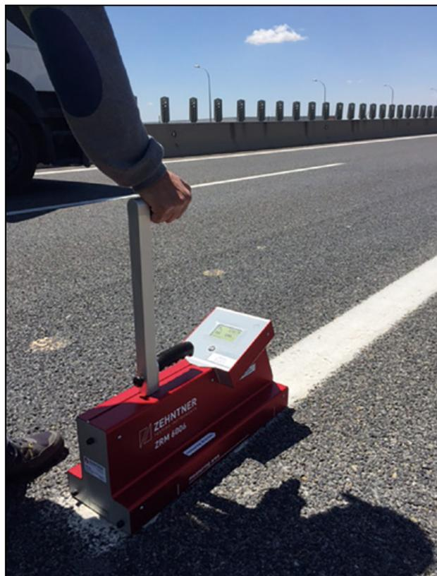
**Figura 7.** Auscultación del indicador I21 (Retroreflexión de marcas viales) con equipos del CEDEX.
