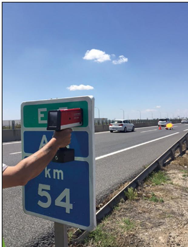
**Figura 8.** Auscultación del indicador I24 (Retroreflexión de señales verticales) con equipos del CEDEX.
