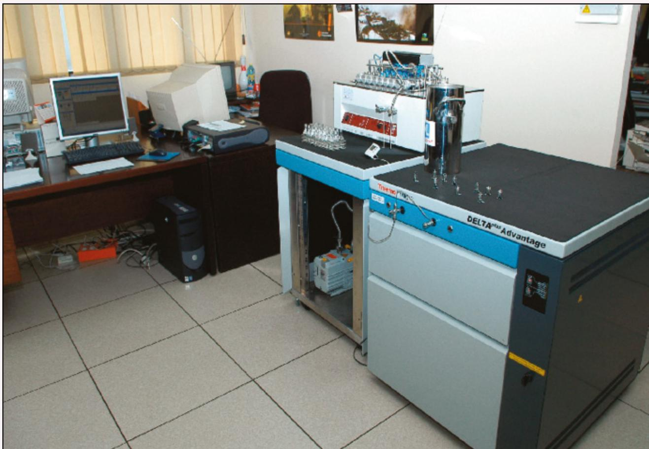
Espectrómetro de masas Finningan Delta Plus Advantage.
