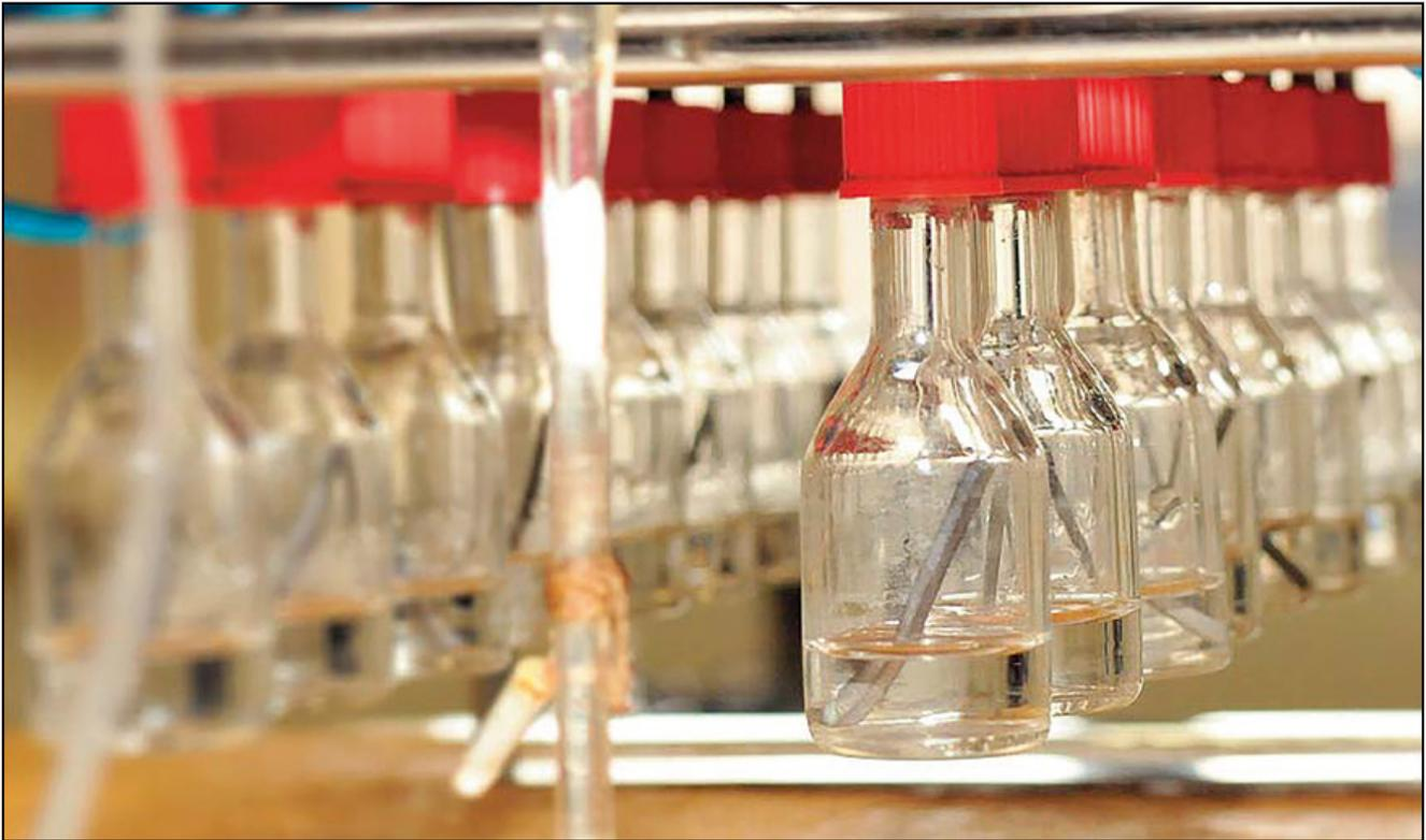
Botellas de equilibrado para el espectrómetro de masas.
