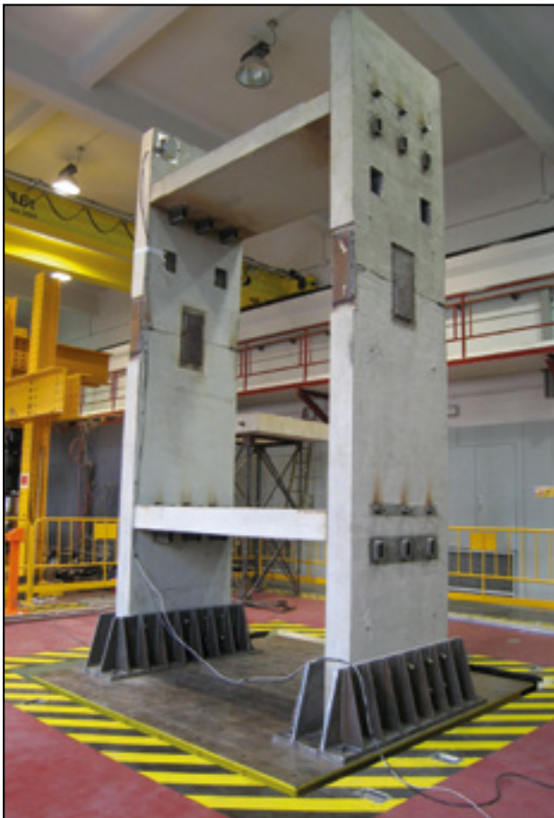
Figura 2. Prototipo de ensayo de paneles prefabricados.
