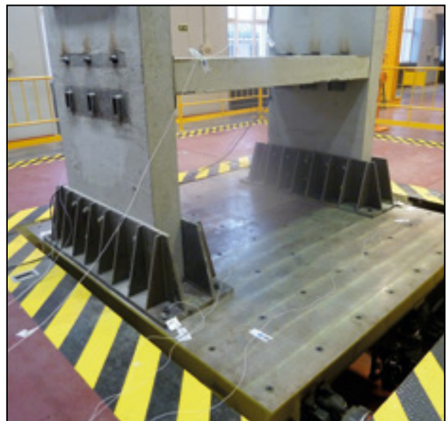
Figura 3. Detalle de la fijación del prototipo de ensayo al simulador sísmico.
