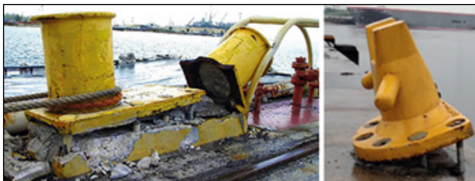
Figura 1. Ejemplo de rotura de bolardo (izquierda) y de su anclaje (derecha).
