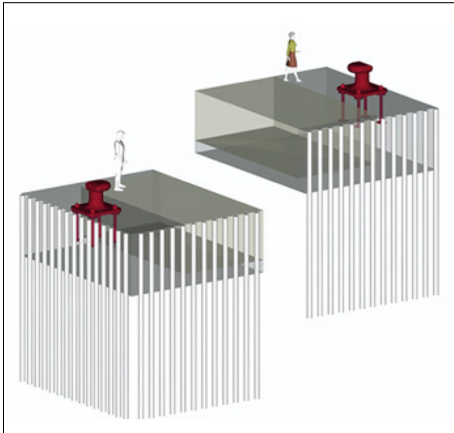
Figura 8. Macizo reforzado con micropilotes.
