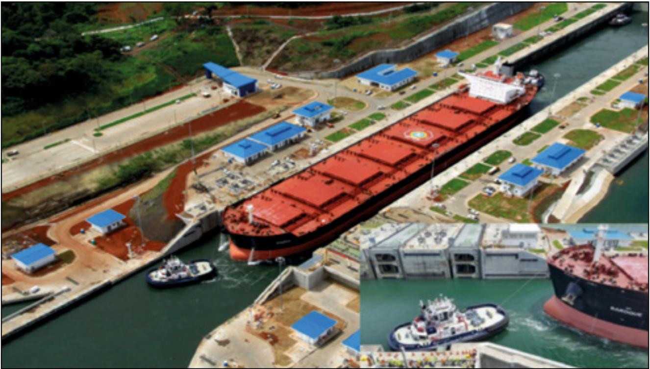
**Figura 48.** Pruebas con buque Baroque (granelero neopanamax de 255 m de eslora y 45 m de manga).
