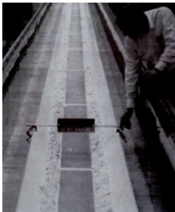
FIGURA 10. Aspecto del montaje medición de trazadores en el canal Caltech, USA.
