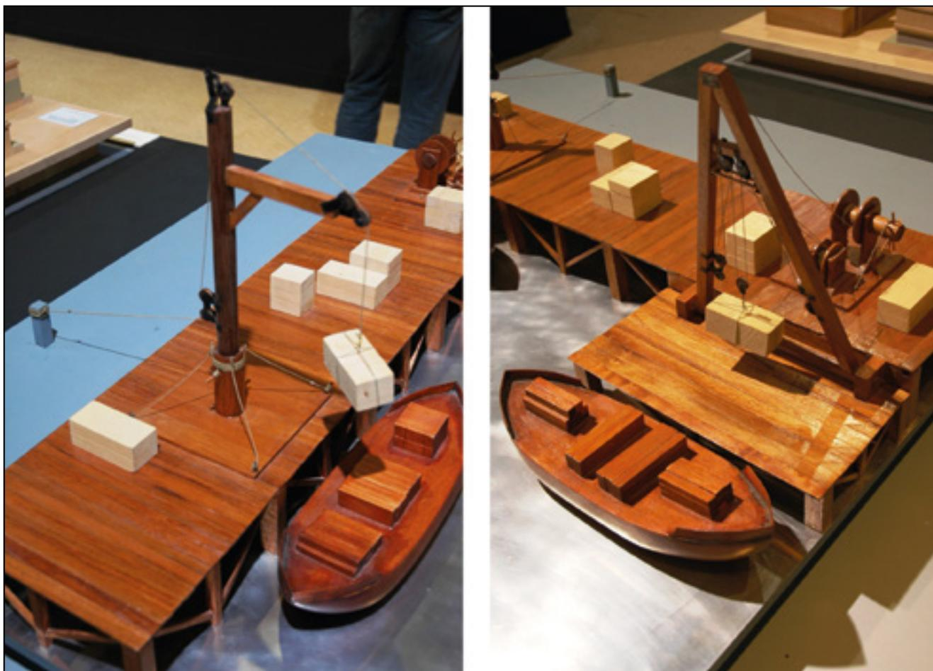
**Figura 15.** Maquetas de grúas romanas portuarias a pie de cantil. A la izquierda de eje vertical y a la derecha de eje horizontal (Exposición Artifex – CEHOPU-CEDEX).
