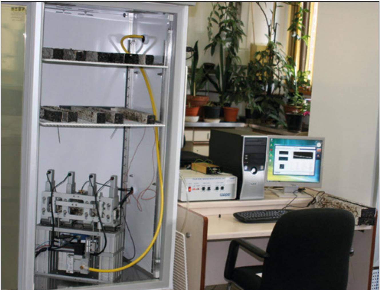
**Figura 4.** Dispositivo de ensayo para resistencia a fatiga en cuatro puntos.
