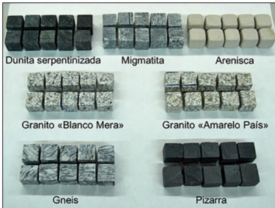
Figura 6. Probetas cúbicas características de un ensayo de durabilidad tipo *Slake*.
