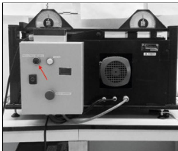
**Figura 3.** Mesa de inclinación para la realización de *tilt tests*, modificada con un potenciómetro (indicado mediante una flecha) para permitir variar en la forma deseada la velocidad de ensayo.
