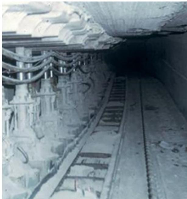
**Figura 6.** Tajo largo con sostenimiento autodesplazable.
