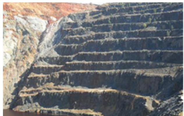
Figura 5. Talud Sur en pizarra en las proximidades de las explotaciones subterráneas rellenas.
