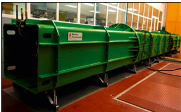
**Figura 4.** Generador lineal de reluctancia conmutada utilizado en el convertidor de energía de las olas.
