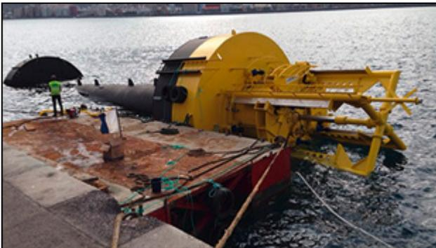
Figura 8. Captador undimotriz durante la botadura en el puerto de Las Palmas de Gran Canaria.
