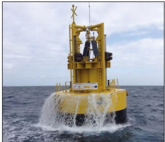
Figura 11. Captador undimotriz durante las pruebas de generación.
