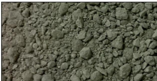
**Figura 2.** Mezcla de escoria de acería de horno eléctrico y caliza.
