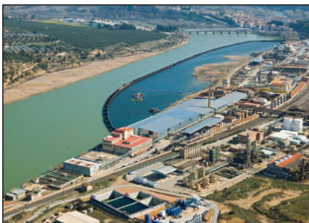
**Figura 5.** Fotografía general y detalle embalse de Flix. Cabe destacar la barrera que impide la propagación de los residuos químicos.
