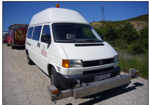
Figura 14. Equipo Perfilómetro del CEDEX.
