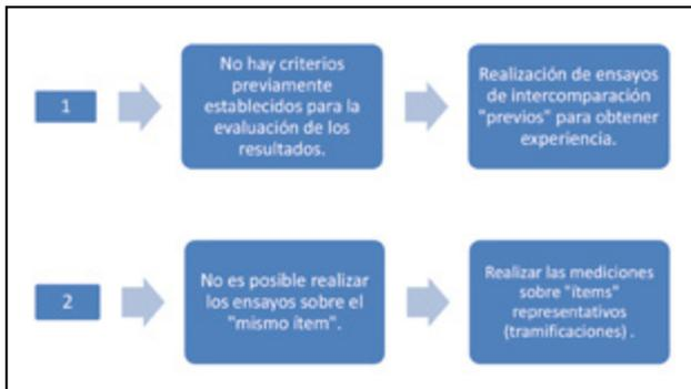
**Figura 4.** Particularidades de los ensayos de aptitud de equipos de medición de características superficiales a la vista de las definiciones de la ISO.
