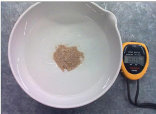
**Figura 12.** Ensayo de Crumb.
