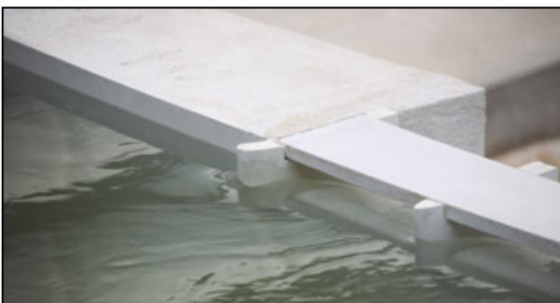
**Figura 11.** Detalle del comportamiento del estribo izquierdo para la Avenida de Proyecto.
