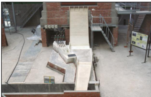
Figura 2. Modelo físico del aliviadero de La Breña II.
