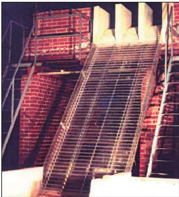
Figura 1. Modelo físico del aliviadero de La Puebla de Cazalla.
