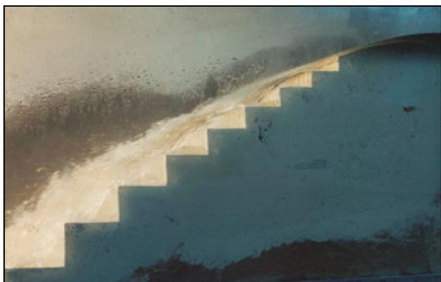
**Figura 17.** Funcionamiento de la solución nº 2 para la transición a la rápida escalonada.
