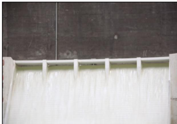
**Figura 19.** Vista global del funcionamiento del vertedero para la Avenida CMP-8.
