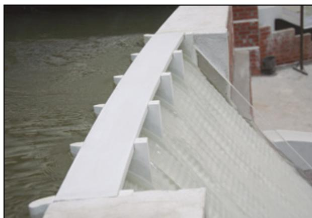
**Figura 20.** Entrada del flujo en la rampa escalonada procedente del perfil de transición para la Avenida CMP-8.
