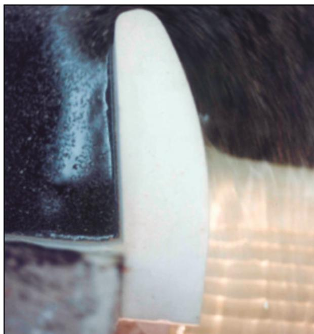
Figura 7. Estribo con depresión de la lámina de agua.
