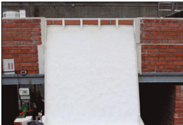
**Figura 24.** Vista frontal del flujo en la rápida escalonada para  $Q = 200 \text{ m}^3/\text{s}$ .
