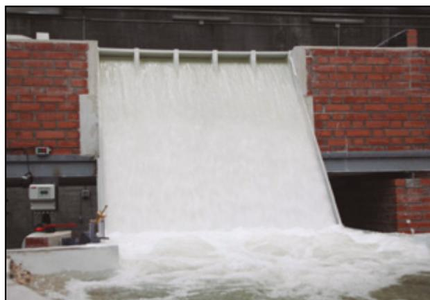
**Figura 26.** Vista frontal del flujo en la rápida escalonada para la Avenida CMP-8.
