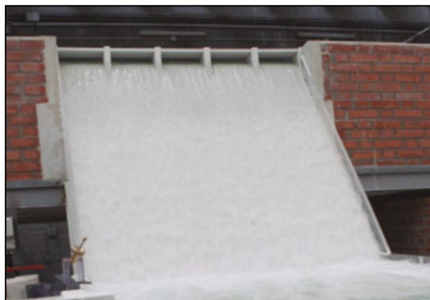
**Figura 25.** Vista lateral del flujo en la rápida escalonada para la Avenida de Proyecto.
