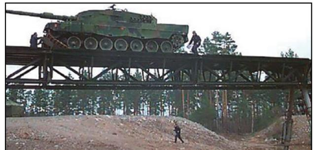
**Figura 11.** El puente militar Fast Bridge 48, con aceros de 460 Y 1.100 MPa.
