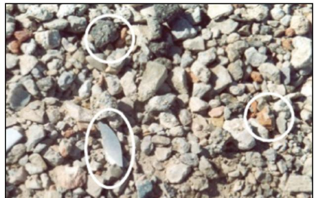
**Figura 6.** Impurezas del árido reciclado.
