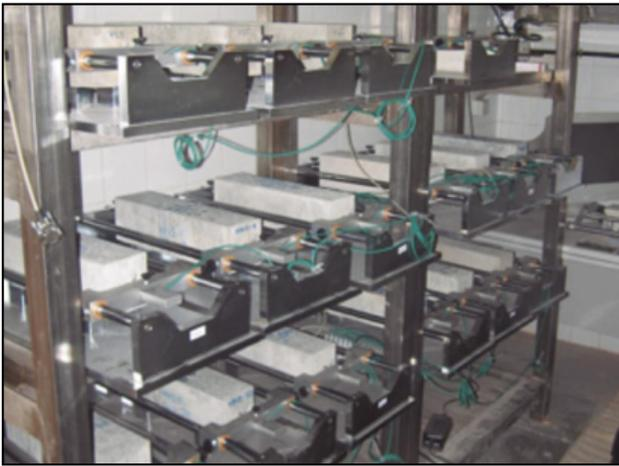
Figura 8. Ensayo de retracción.
