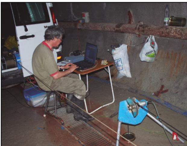
**Figura 29.** Testificación geofísica en el interior de un sondeo de la galería.
