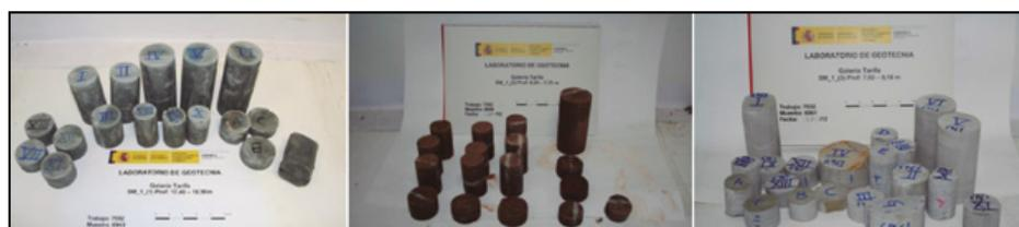
**Figura 34.** Muestra de algunas de las probetas talladas con testigos de cada zona (de izquierda a derecha: Zonas 1, 2, y 3).
