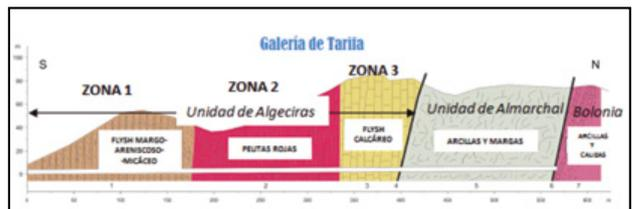
Figura 20. Perfil geológico simplificado de la galería experimental de Tarifa (facilitado por SECEGSA).
