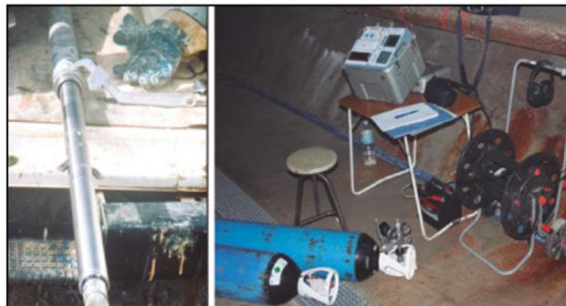
**Figura 27.** Sonda y equipo de medida para los ensayos presiométricos tipo OYO.
